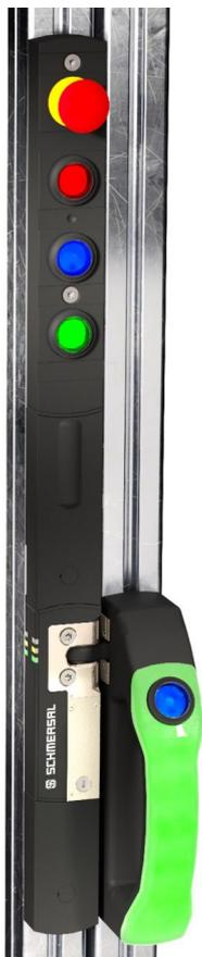
Este painel de controlo pode ser instalado rapidamente e sem erros graças a um conector M12 plug-and-play de 12 pinos. Com tampas opcionais para ocultar a ligação, o painel não só oferece proteção contra adulteração para o cabo de ligação, como também oferece um design limpo para a unidade de controlo.
