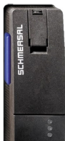
3 LEDs coloridos para sinalização: Verde = Alimentação Amarelo = Estado Vermelho = (intermitente) Erro de diagnóstico
