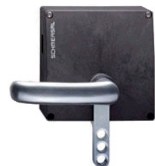
O dispositivo de bloqueio integrado opcional no manípulo da porta é um dos três métodos de bloqueio. O atuador retrai-se para dentro da caixa do manípulo da porta quando aberto (alça na horizontal)
