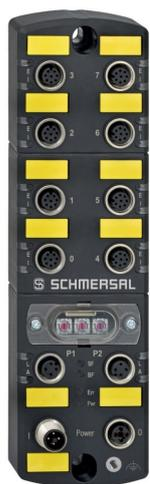
A caixa de campo de segurança SFB permite a instalação simples plug-and-play de até oito dispositivos de segurança por caixa, com interface de bus de campo superior e inferior. Está disponível para os protocolos de bus de campo PROFINET com PROFIsafe, EtherNet/IP com CIP Safety ou EtherCAT com FSoE.
